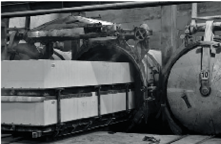
Rysunek 5.4. Autoklawizowany beton komórkowy po procesie autoklawizacji
