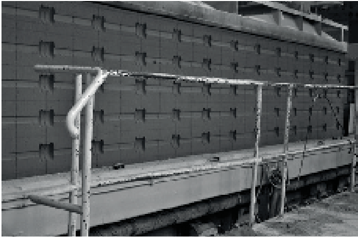
Rysunek 5.3. Krojenie masy betonu komórkowego
